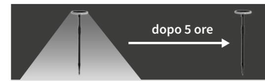
**Modalità B:** al calare della sera la lampada si accende automaticamente al massimo della luminosità e **resta accesa fissa fino all'esaurimento completo della carica.**
